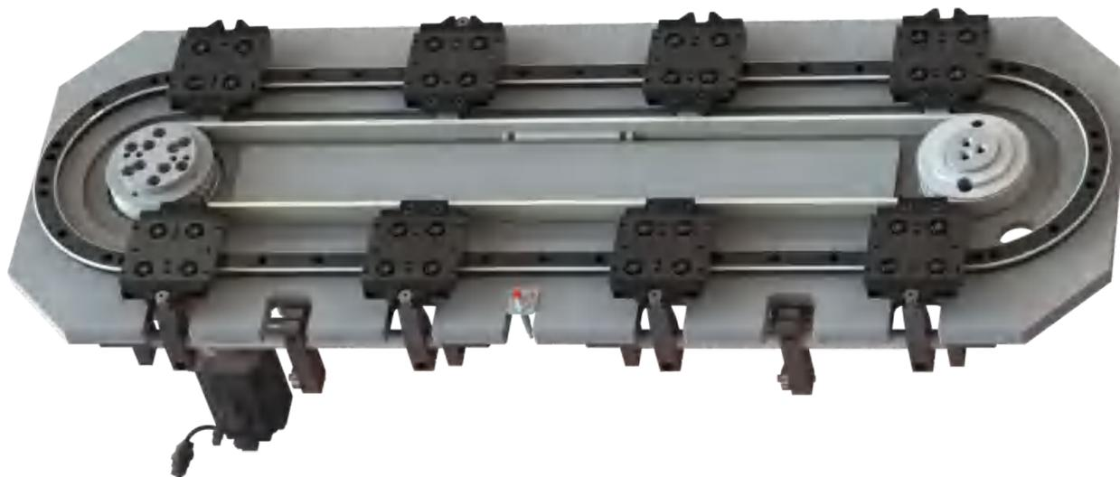
○ 滑座: 可选用钢质或铝质板材经行精密加工, 经过严格的质量控制及精湛的调装工艺, 可使滑座在X-Y-Z方向精度达到HP级, 即 $\leq \pm 0.05\text{mm}$
